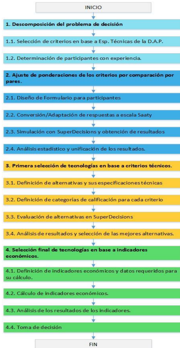
Figura 6 Diagrama de bloque de Metodología para Seleccionar tecnologías más eficientes para Sistemas de Alumbrado Público.
