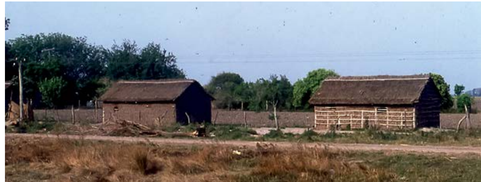
El entramado de elementos vegetales y tierra es un sistema típico del área guaraníca. / Foto: R. Alexander. Colección CEDODAL
