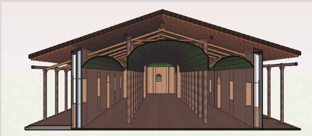
Lámina No. L-19. Sección tridimensional del templo, muestra la adición de bóvedas falsas de madera por debajo del sistema de par y nudillo que soporta la cubierta.
