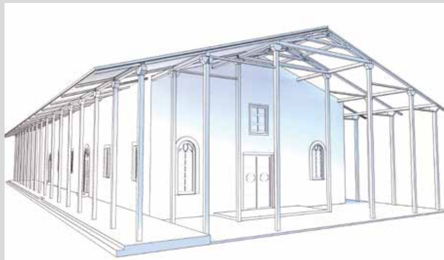
Construcción del padre Lara con soportes internos y externos de madera, siguiendo la tradición constructiva local.
