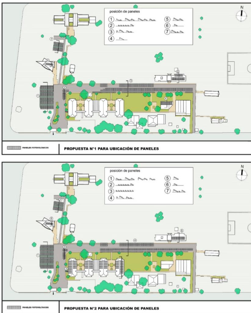
Figura 5. (a) Propuesta para el emplazamiento de módulos fotovoltaicos en arreglos que provean sombra en áreas de parques. (b) segunda propuesta ubicando algunos módulos en las caídas de techos de algunos edificios del campus.
