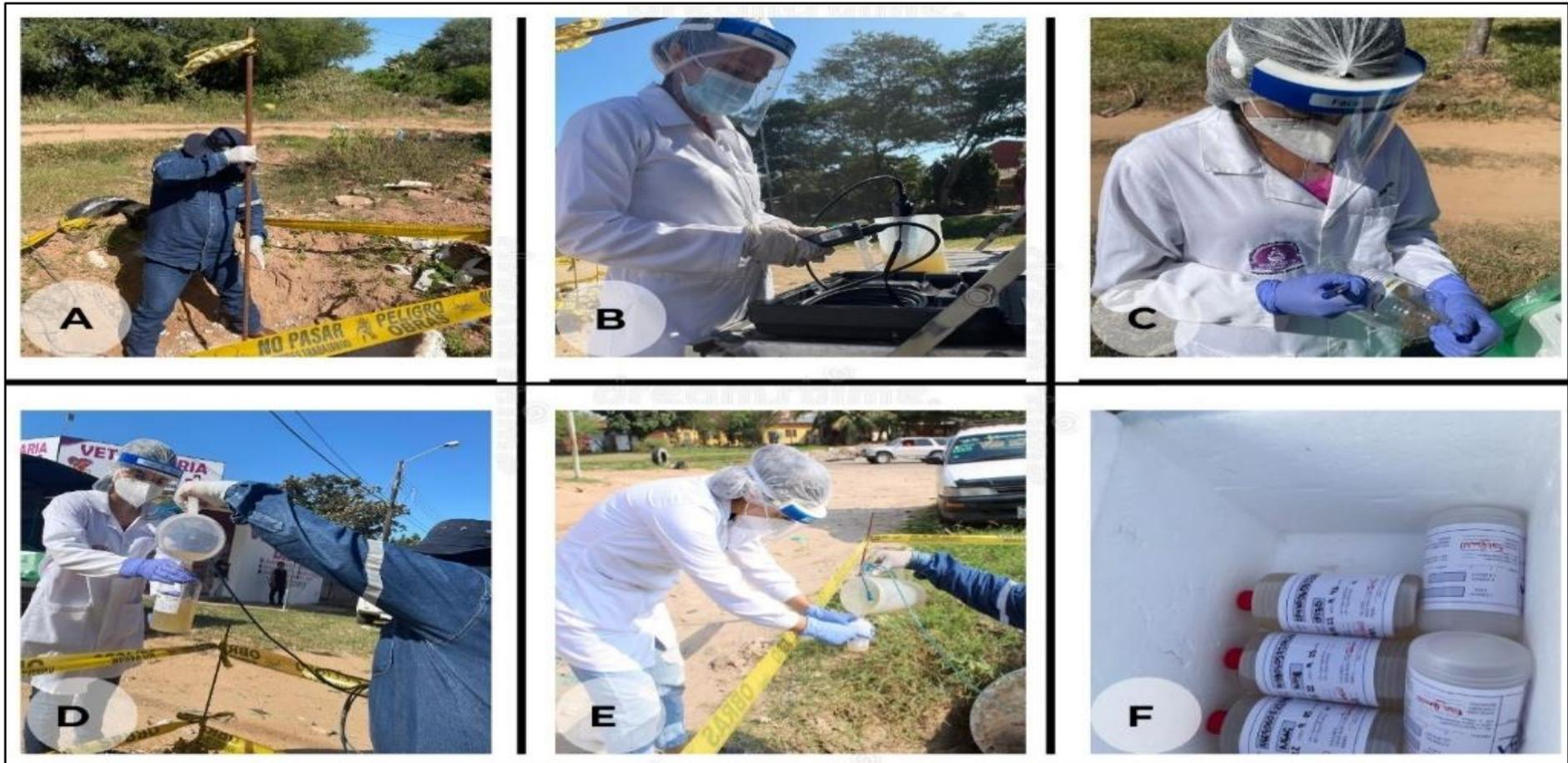
**A:** Medición de tirante **B:** Parámetros in situ **C:** Etiquetado **D:** Toma de muestra para análisis molecular **E:** Toma de muestra para análisis microbiológicos y fisicoquímicos **F:** Conservación y transporte de la muestra.
